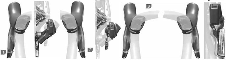
Ritzel. Halten Sie den Schalthebel gedrückt, um mehrere Gänge auf einmal zu schalten. Durch Antippen des rechten Schalthebels bewegt man das Schaltwerk nach außen. Die Kette wandert zum nächstkleineren Ritzel. Werden sowohl der linke, als auch der rechte Schalthebel gleichzeitig gedrückt, wandert die Kette über den Umwerfer auf das kleine bzw. große Kettenblatt vorne.
