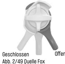
Ist die Druckstufe geschlossen, bietet der Dämpfer ein hartes Ansprechverhalten. Bei offener Druckstufe ist das Dämpfungsverhalten weicher.
