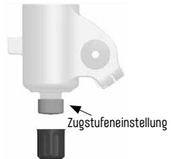
Abb. 2/47 Zugstufe Quelle: Fox
